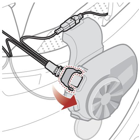
**Remarque :** Vous pouvez utiliser le support de microphone sur tige après avoir fixé dessus la fermeture scratch qui permet de le maintenir solidement.
