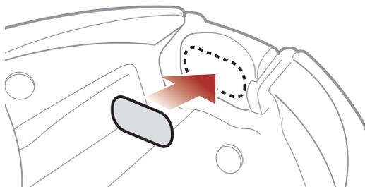
2. Fixez le microphone câblé à la fermeture scratch prévue à cet effet.
