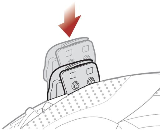
3. Serrez les deux vis jusqu'à ce que la pince de fixation soit fermement fixée au casque moto.
