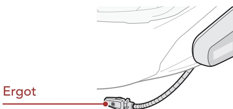
4. Alignez les flèches sur les câbles du microphone et du haut-parleur, et insérez le câble du microphone dans celui du haut-parleur.
