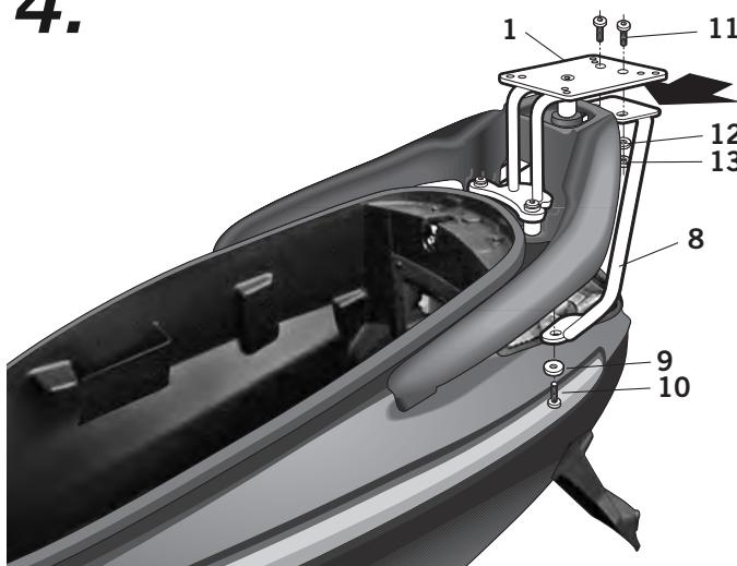
**E** Posicionar el soporte inferior KIT TOP (8) al transportin mediante las arandelas (9) y los tornillos (10), lo unimos al soporte superior KIT TOP (1) mediante los tornillos (11), las arandelas (12) y las tuercas (13).
