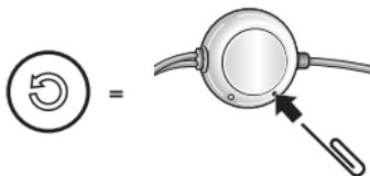
Appuyez sur le **bouton de réinitialisation en trou d'épingle** pendant une seconde en exerçant une légère pression. Le casque audio s'éteint automatiquement et une réinitialisation par défaut est lancée.
