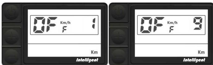
Diamètre de la roue : L'emplacement de la vitesse est indiqué par le symbole Wd, appuyez sur le bouton UP/DOWN. Tournez le bouton pour afficher le symbole 16/18/20/22/24/26/700 C/28/29, la valeur représente le diamètre de la roue (en pouces). Une mauvaise valeur de diamètre de roue entraînera une vitesse et un kilométrage anormaux.
