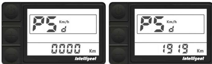
Fixation de la limite de vitesse : Emplacement du symbole de vitesse SPL, emplacement du kilomètre affiche la valeur limite de vitesse, la valeur par défaut est 25 km/h. Appuyez sur le bouton HAUT/BAS. pour modifier la valeur, la valeur peut être réglée entre 10 et 45 km/h. Appuyez sur le bouton POWER pour confirmer lorsque le réglage est terminé.
