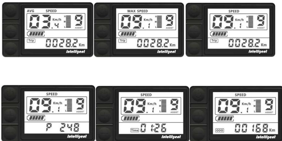
Commutateur de mode de vitesse et commutateur de mode de kilométrage
