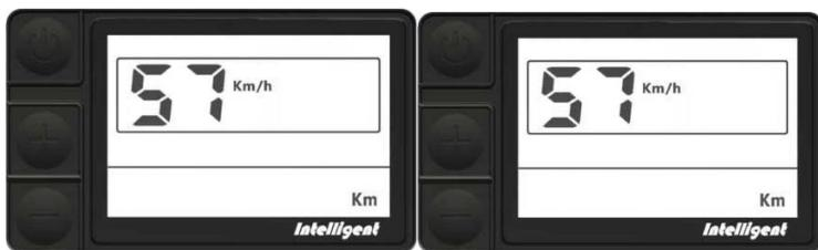
Luminosité du rétroéclairage : emplacement du symbole d'affichage de la vitesse bL1, appuyez sur. Le bouton HAUT/BAS affichera le symbole 1 à 5 pour modifier la luminosité du rétroéclairage.
