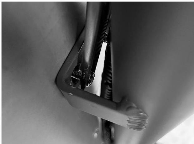
Figure 25 - Raccords vissés de la caisse de chargement - fixation au tube de direction
