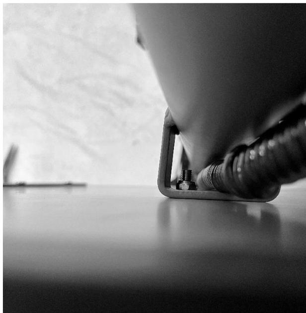
Chaque raccord à vis qui fixe le coffre au cadre du vélo est toujours équipé d'une vis et d'un écrou avec une rondelle plate.
