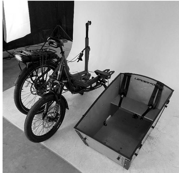
Desserrez progressivement toutes les vis qui fixent la caisse au cadre. Conservez soigneusement les vis, retirez la caisse du cadre et placez-la de côté.
