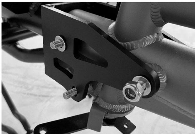
Serrez soigneusement tous les raccords vissés avec un couple de serrage minimum de 25 Nm.
