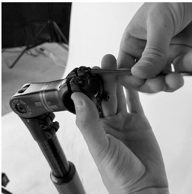
Placez le guidon dans la douille de potence et au centre. Vérifiez à nouveau que les câbles et les tubes ne sont pas tordus ou pliés et qu'ils mènent au cadre et à la fourche selon l'arc le plus large possible. Remplacez la plaque frontale de la tige. Serrez les vis de serrage de la façade uniformément en croix jusqu'à ce que le guidon soit légèrement maintenu en place. Placez le guidon dans la bonne position afin que les leviers de frein soient légèrement dirigés vers le bas.
