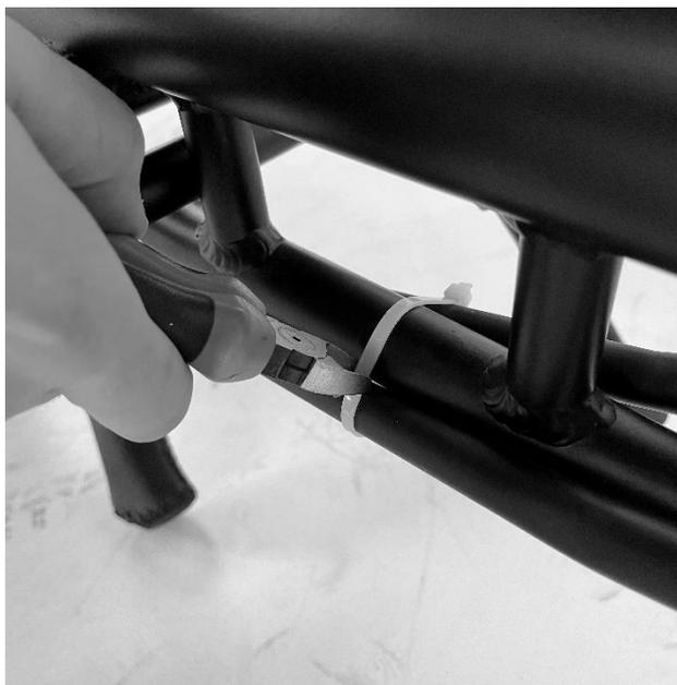
Concentrez-vous maintenant sur la jonction principale de l'avant et de l'arrière du cadre. Assurez-vous que le faisceau de tubes et de câbles provenant du tube de direction est situé sous la partie en acier de la bride du cadre avant.
