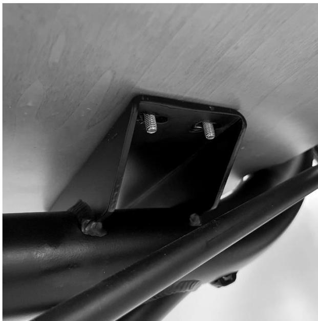
Montez ensuite la boîte de chargement sur la structure du tube de direction.
