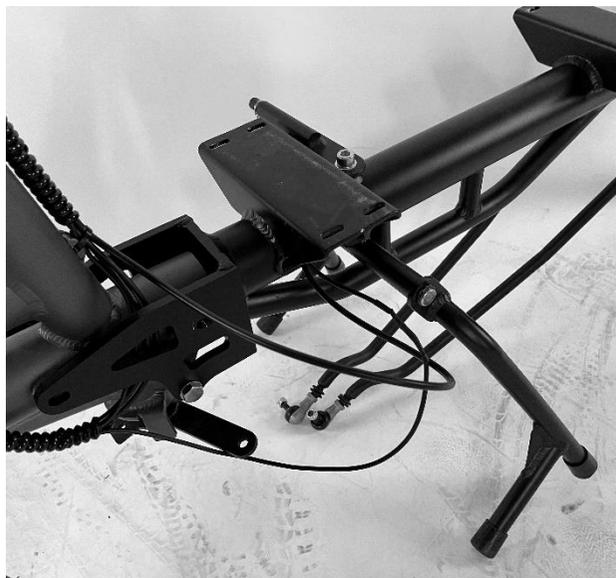
Figure 11 - Acheminement correct des câbles et des tuyaux
