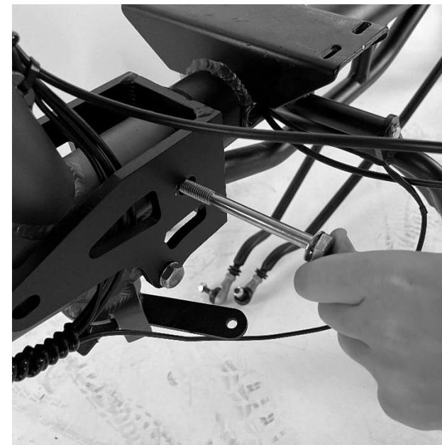
Glissez d'abord une rondelle plate sur chaque vis puis vissez l'écrou.
