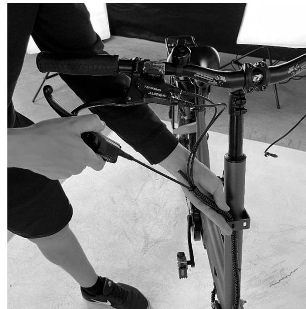
Retirez la partie avant de l'étrier du levier de frein avant. Placez le levier sur le côté gauche du guidon et installez la partie avant de l'étrier. Serrez légèrement les vis puis vérifiez la bonne position du levier qui doit pointer légèrement vers le bas. Maintenant, serrez fermement les boulons de l'étrier du levier.
